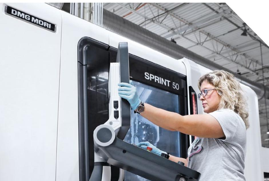
Оператор Эрика Уильямс работает на станке SPRINT 50. Этот токарный станок осуществляет автоматическую токарную обработку прутков и деталей патронов с макс. 36 инструментальными позициями.
