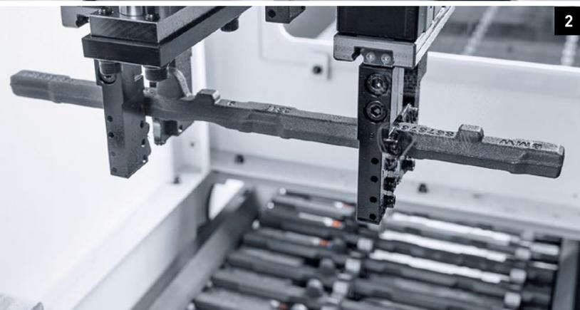
1. В 2016 году компания Eisenwerk Erla создала автоматизированное механическое производство из 18 соединенных в линию станков NLX 2500 2. Робот снимает заготовки с конвейера
