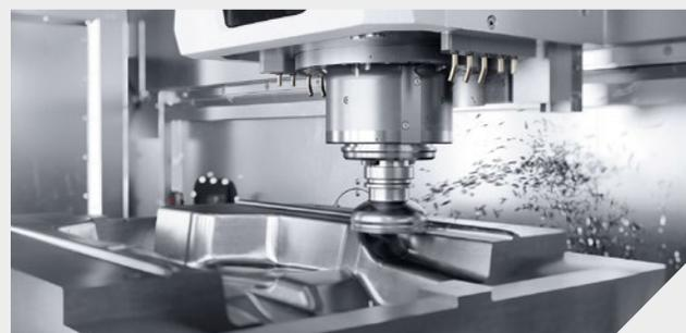
Шпиндель inlineMASTER\* со скоростью 15 000 об/мин, опционально – speedMASTER на 20 000 об/мин или 200 Нм, а также шпиндель powerMASTER\* на 288 Нм (SK50).
