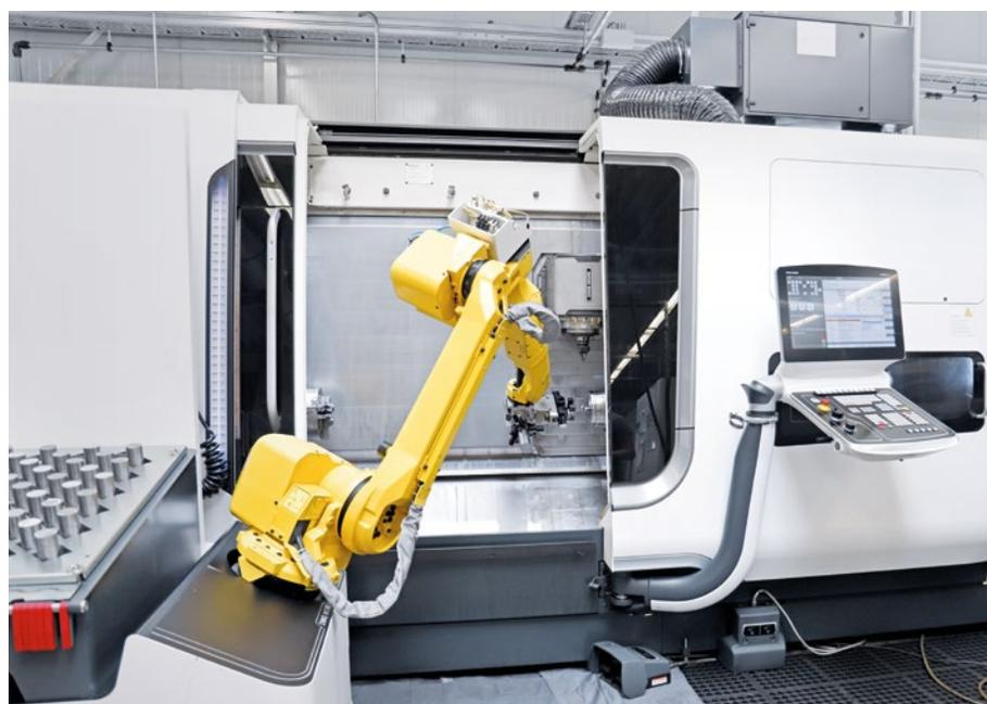
Выгрузка готовой детали Robo2Go из контршпинделя.
