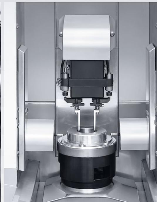
Станция для измерения параллельно главному времени.
