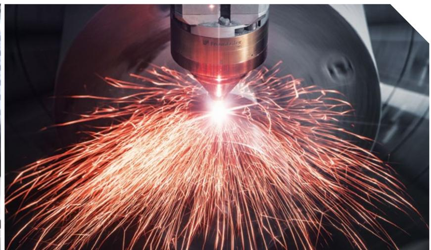
С 2017 года Schaeffler использует в AM FabShop станок **LASERTEC 65 3D hybrid**.
