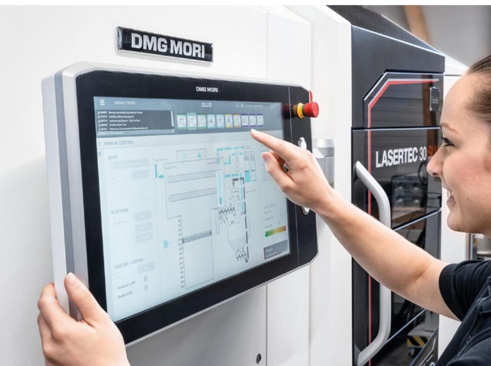
LASERTEC 30 *SLM* 2-го поколения оснащен единым интерфейсом управления CELOS.
