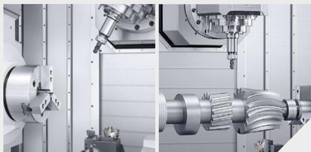
6-сторонняя комплексная обработка сложных заготовок до  $\varnothing 670$  и длиной 1500 мм с фрезерно-токарным шпинделем compactMASTER и вторым держателем инструмента (нижней револьверной головкой) с осью Y 80 мм.
