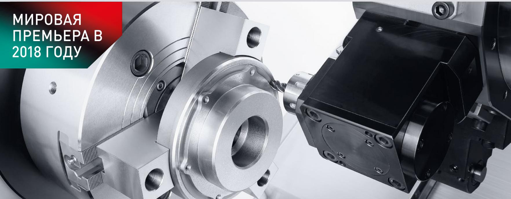
Револьвер ВМТ со скоростью макс. 6000 об/мин и макс. 15,9 Нм для обработки приводными инструментами.
