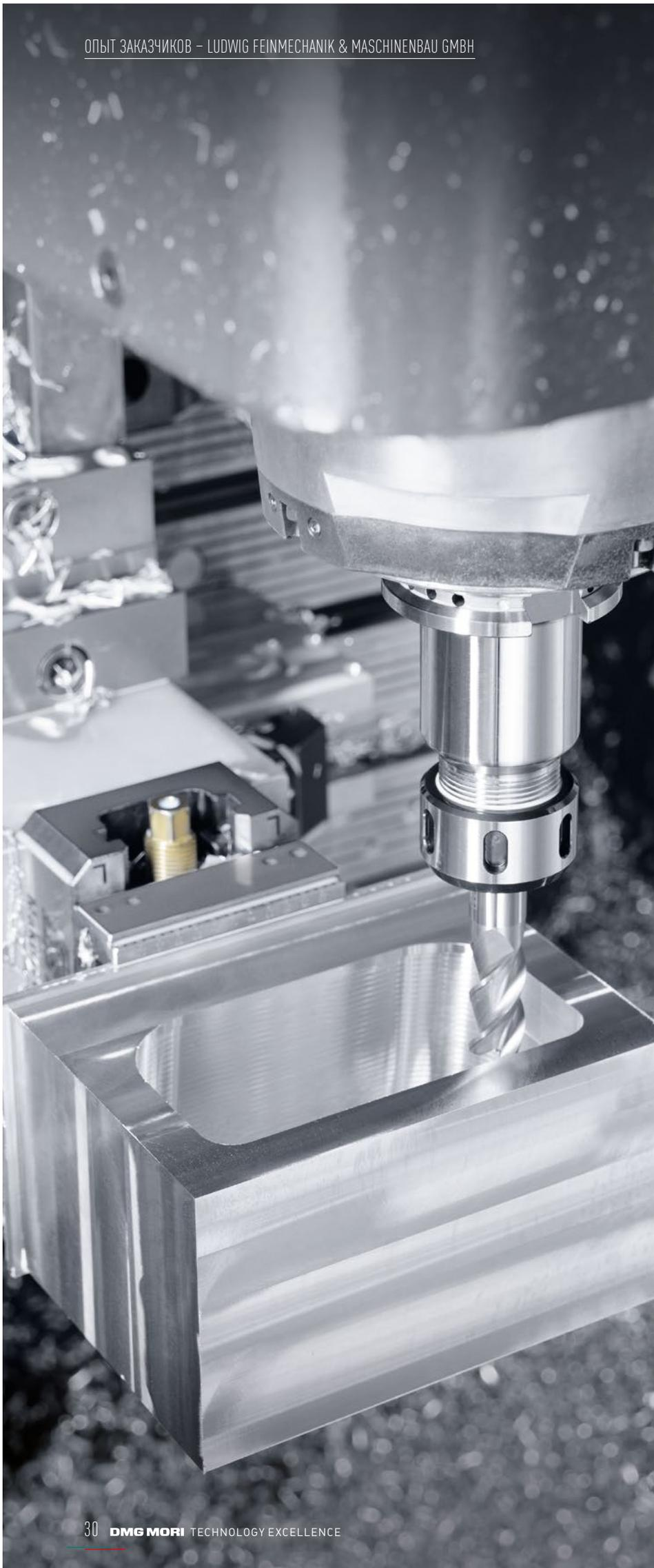
диапазоне”, – считает Франк Варнке. Диапазон поворота компактного 5-осевого обрабатывающего центра составляет от  $-35^{\circ}$  до  $+110^{\circ}$ , шпиндель speedMASTER работает на скорости 20 000 об/мин при 35 кВт и 130 Нм. Теперь DMG MORI дает на все шпиндели серии MASTER гарантию на 36 месяцев без ограничения часов
