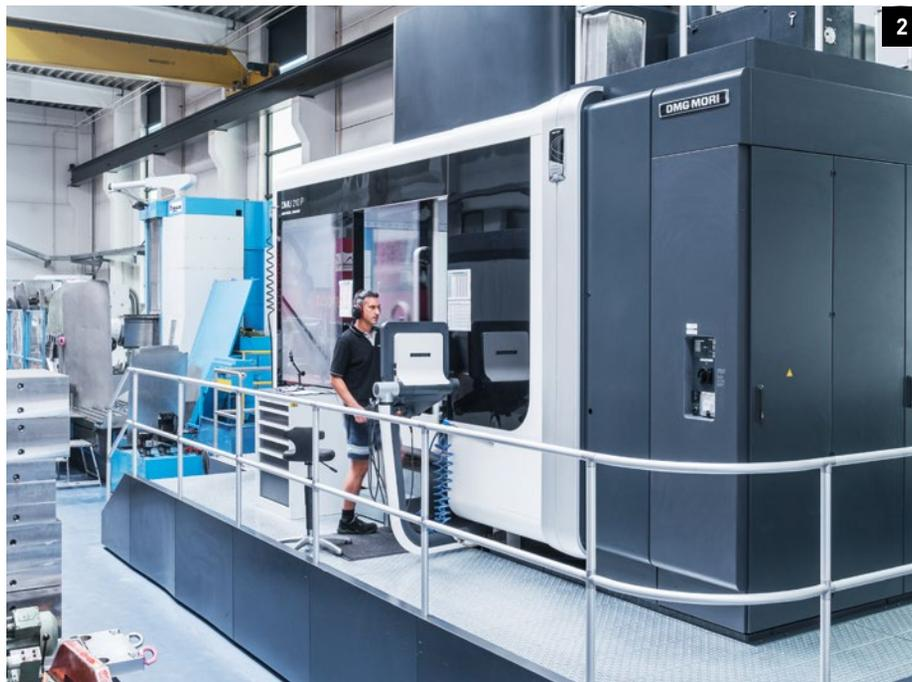
1. Шпиндель HSC станка HSC 105 *linear* со скоростью вращения до 40 000 об/мин и линейные приводы для ускоренного хода 90 м/мин позволяют осуществлять очень точную обработку графита с идеальными поверхностями.
