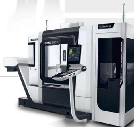
**iLoading на DMC 650 V:** максимальный вес заготовки 5 кг; максимальные габариты заготовки 80 × 80 × 80 мм; реализуемое время цикла до 8 секунд на деталь
