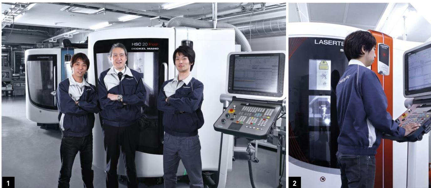
1. Слева направо: Юки Катаока, инженер, Кацуо Ивахори, руководитель и Теруказу Мицугути, инженер, рядом с высокоскоростным обрабатывающим центром HSC 20 *linear*. На фоне также виден ULTRASONIC 20 *linear*. 2. 5-осевая лазерная резка при помощи LASERTEC 20 FineCutting производится в комнате с контролируемым температурным режимом ввиду повышенных требований к точности изделий
