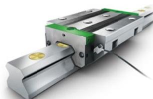
**Элемент качения с циркуляцией роликов RUE 4.0** с пьезоэлектрическими измерителями ускорения в сочетании с системой повторной смазки FAG Concept8 для автоматической подачи смазочного материала.
