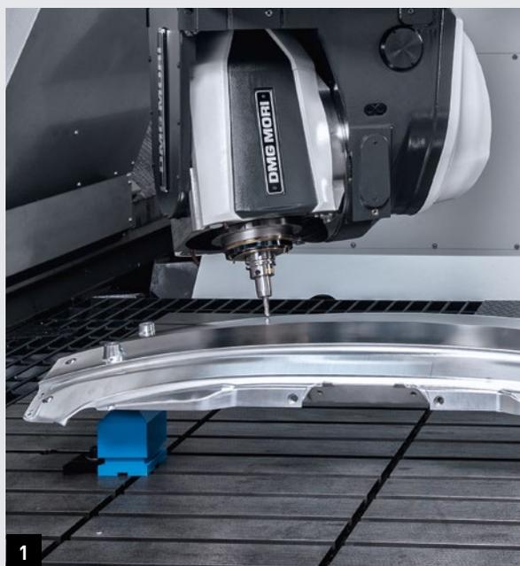
1. Фрезерная головка 45° или 90° для 5-осевой обработки со скоростью вращения до 30 000 об/мин
